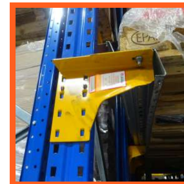
deformierte Palettenaufnahme eines Einschubregals
