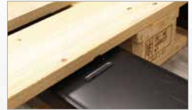
Gelasserte Markierung an Gabeln für optimale Position des Hubwagens bei seitlichem Einfahren in Palette
